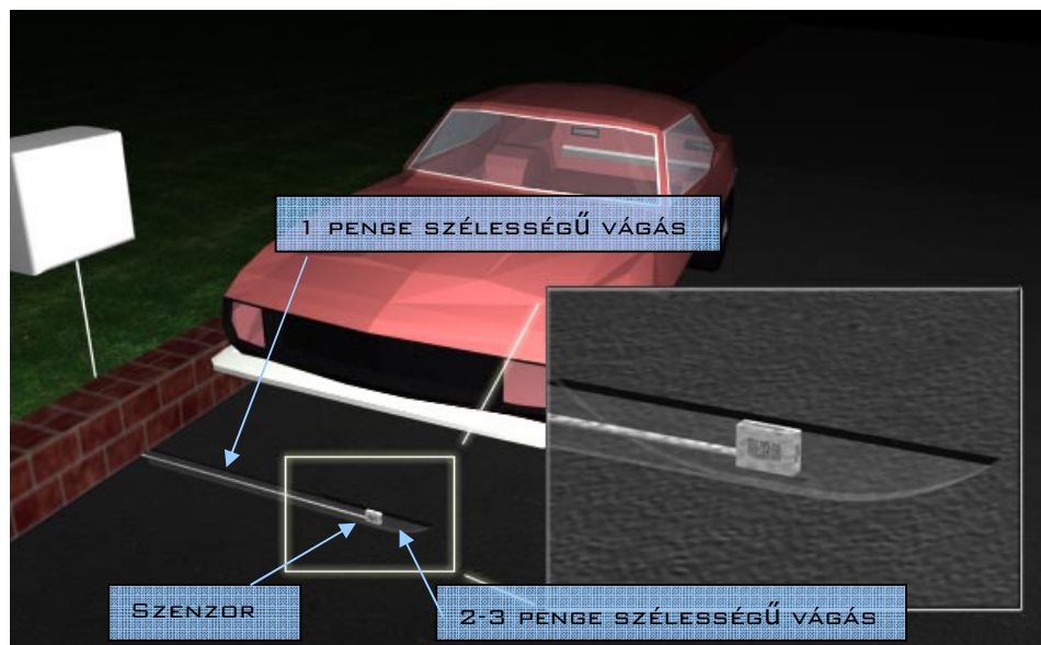
1. ábra. a szenzor telepítése föld alá
